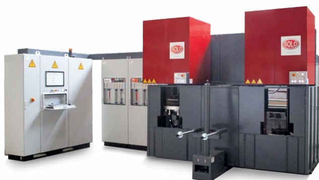
2 Halbautomatische Öfen und 1 Abschreckbad
